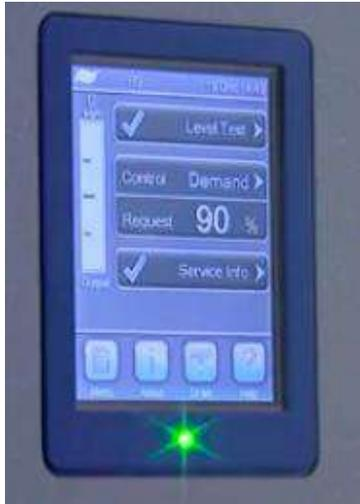
3. El display, muestra una barra vertical en color azul, indicando cuánto vapor está generando, y se muestra un led de color verde indicando que no hay fallas.
